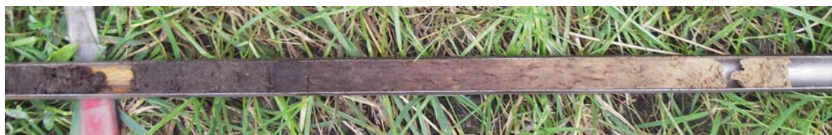
Figuur 10: Deze foto toont één van de boringen (in dit geval boring 361) waarin een laagje venig zand is aangetroffen met daaronder een sterk doorwortelde zandlaag.
