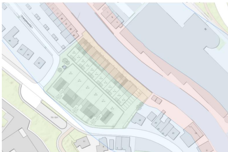
Figuur 3 | De keringzones op de projectlocatie. In roze de waterstaatswerkzone en in blauw de beschermingszone. Bron: memo DM 1389410 9 mei 2018.
