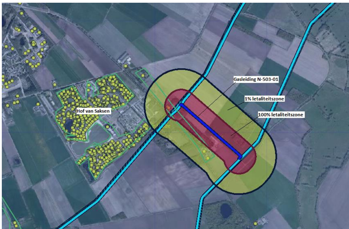
Figuur 5.8: situering gasleiding (blauw) en invloedsgebieden van de gasleiding (rood=100% letaliteit en geel=1% letaliteit)
