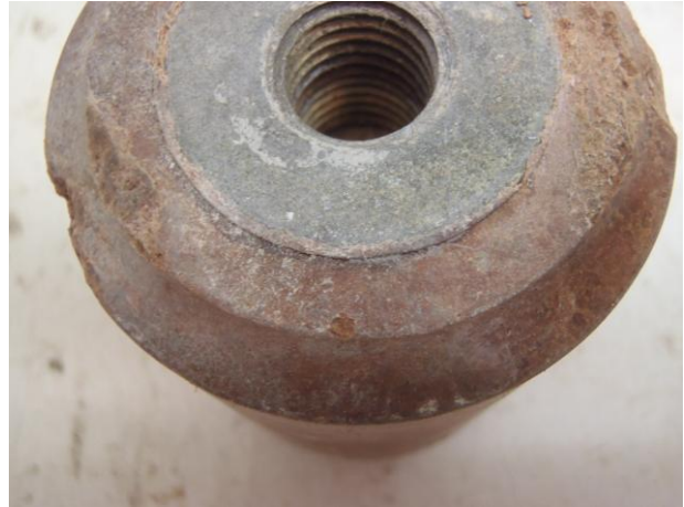
Toelichting bij foto 2: Foto 2 Afstandhouder pakking tussen schroefdraad en buitenmantel
