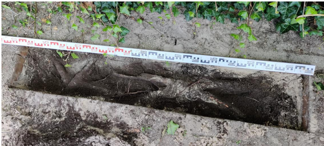
Figuur 6 Proefsleuf 2 is gevraagd direct aan de ander zijde van de schutting, op circa 2,3 meter uit het hart van de boom. Onder de verharding worden in en direct onder het stelzand stabiliteitswortels gevonden van meer dan 5 cm doorsnee.
