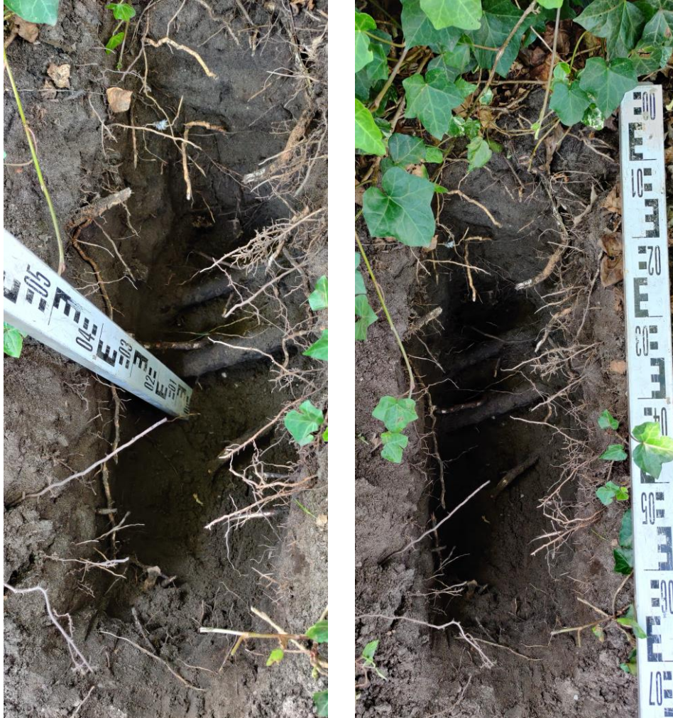
Figuur 5 Profielsleuf 1 is gegraven op circa 3 meter vanuit het hart van de boom in de richting van de ontwikkeling. De noordwestelijke hoek van de bestaande schuur staat op circa 4 meter vanuit het hart van de boom. In de sleuf worden op 40 cm diepte stabiliteitswortel aangetroffen van circa 4 cm doorsnee. De opnamewortels zijn waarschijnlijk voornamelijk afkomstig van de Hedera helix .
