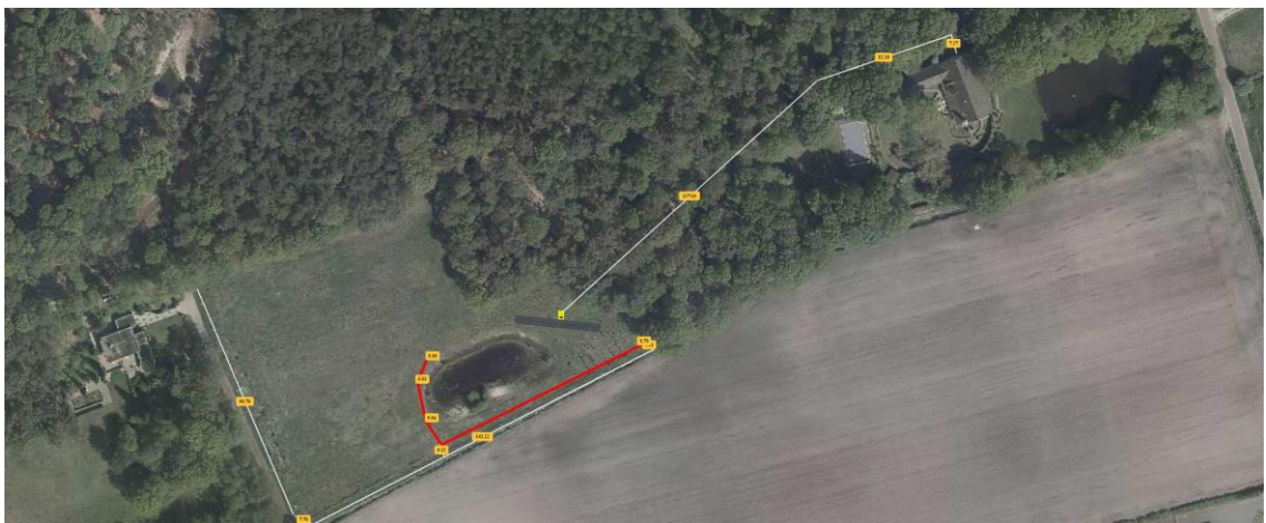
Figuur 4: exacte legplan, met hierop de struweelhaag (rood), de panelen (grijs) en de bekabeling richting het woonhuis (wit)
