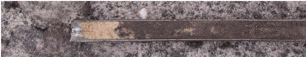
Figuur 13: Foto van boring 2 met daarop links het schone zand van de C-horizont en rechts de met brokken geel zand vermengde bouwvoor
