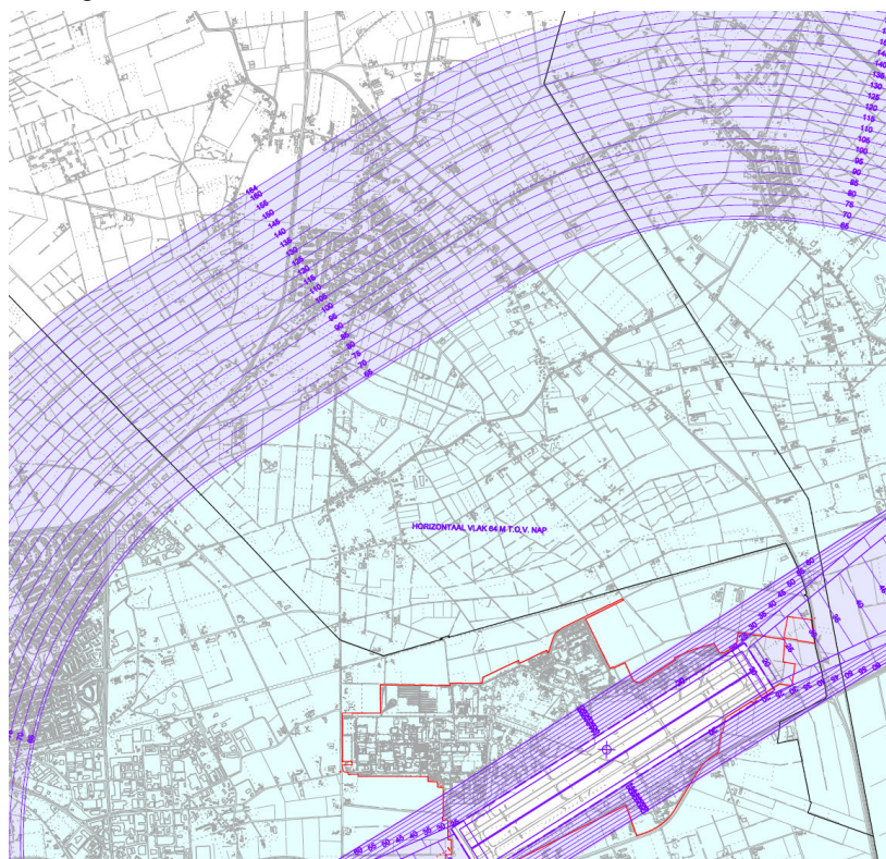
Hoogtebeperkingen t.o.v. NAP ten gevolge van het obstakelgebied funnel/IHCS vliegveld Volkel (hoogte vliegveld en gronden daaromheen +18 - +22 NAP)
