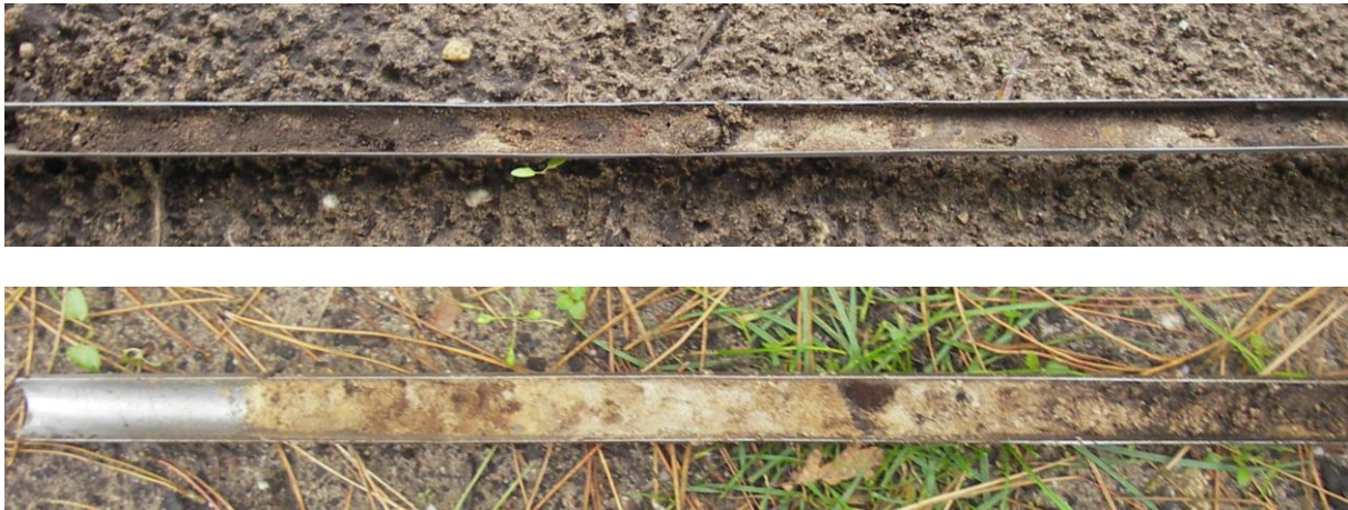
Figuur 16a en b: Voorbeelden van de sterk verstoorde bodemopbouw zoals deze nagenoeg overal binnen het plangebied is aangetroffen (boringen 5 en 36).
