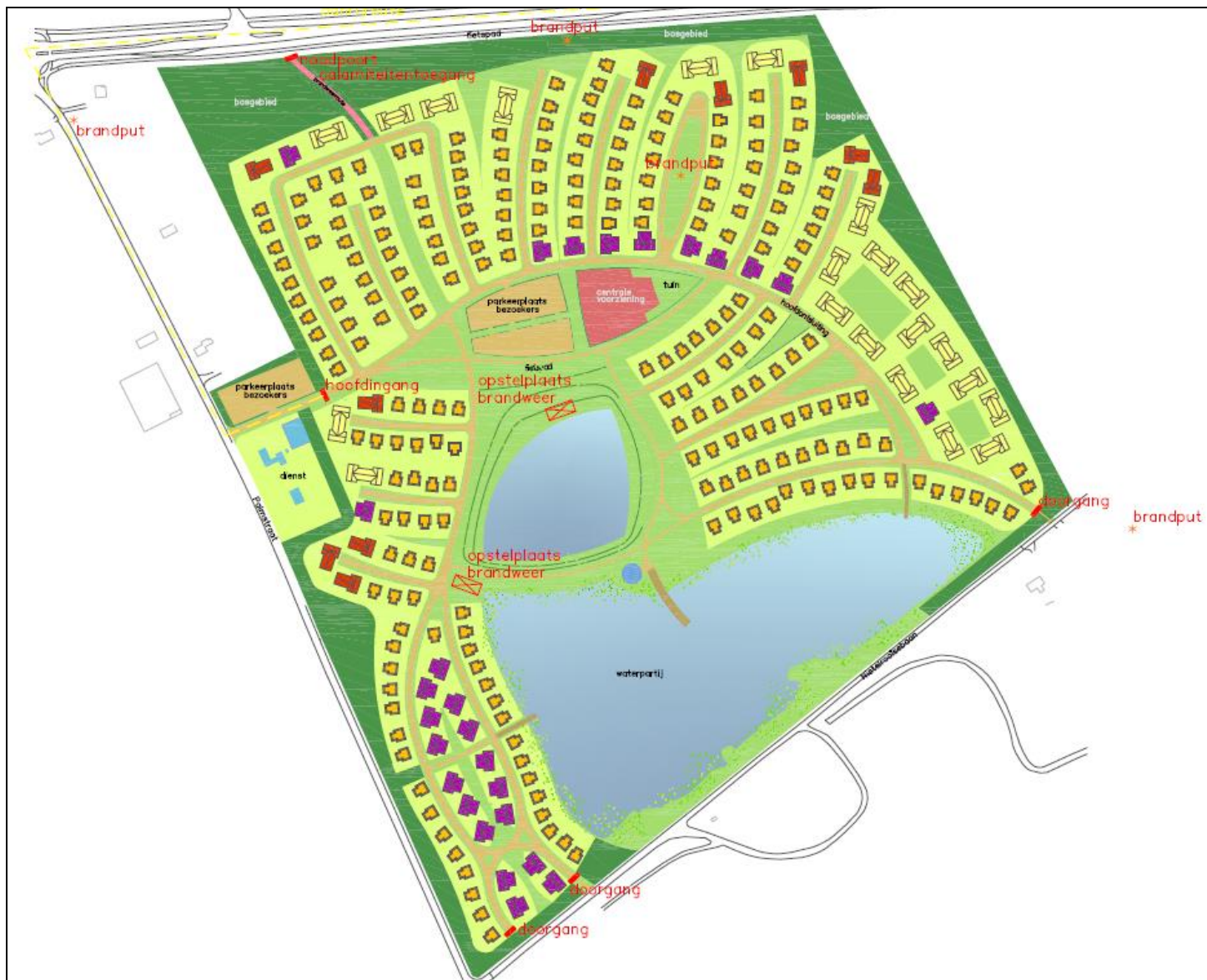
Brandveiligheidsvoorzieningen recreatieoord De Maashorst
