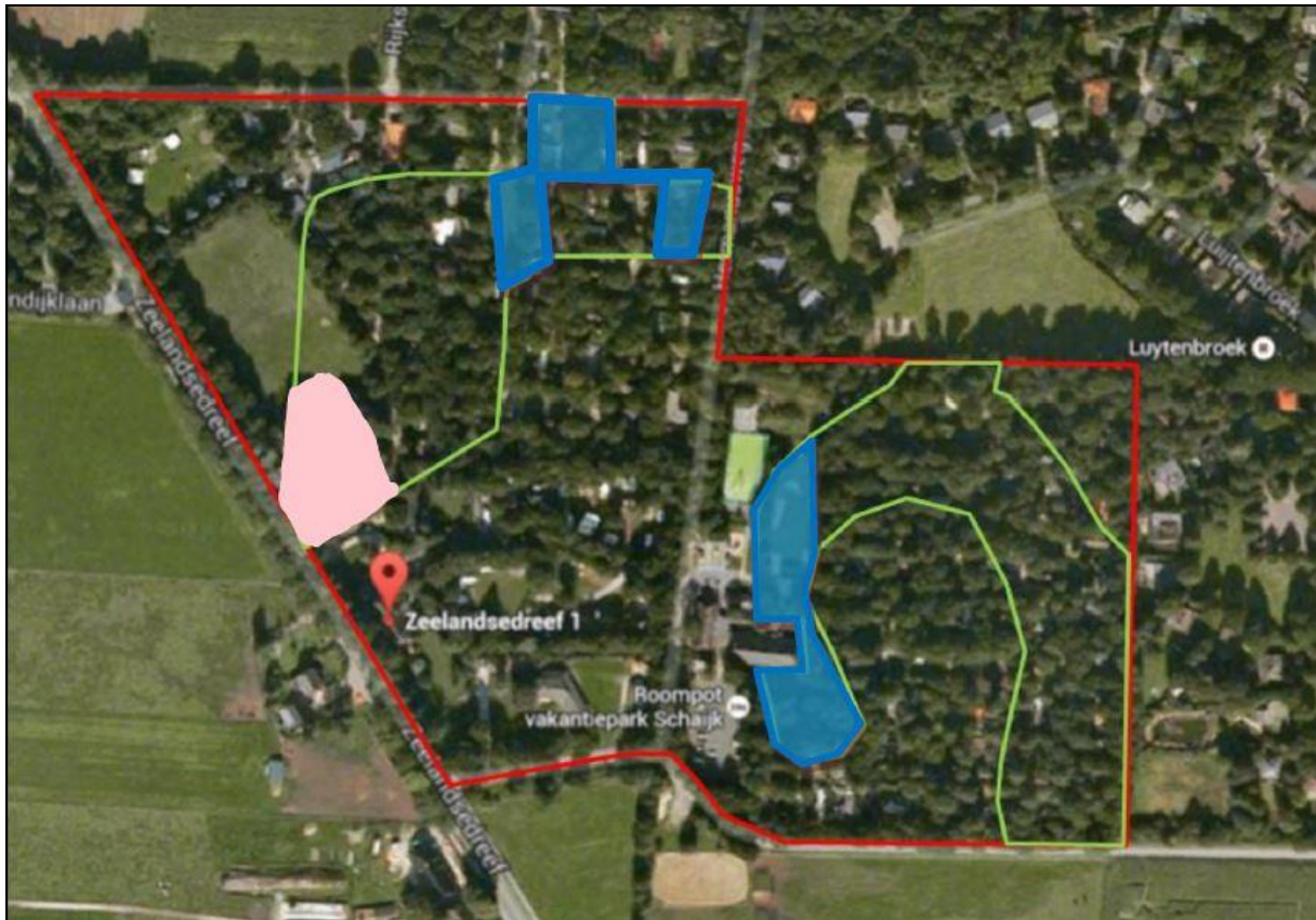
Contouren van de ten dele intacte bodemprofielen (groene kaders). De blauwe zones zijn verstoord, het roze deel valt buiten de uit te voeren werkzaamheden.
