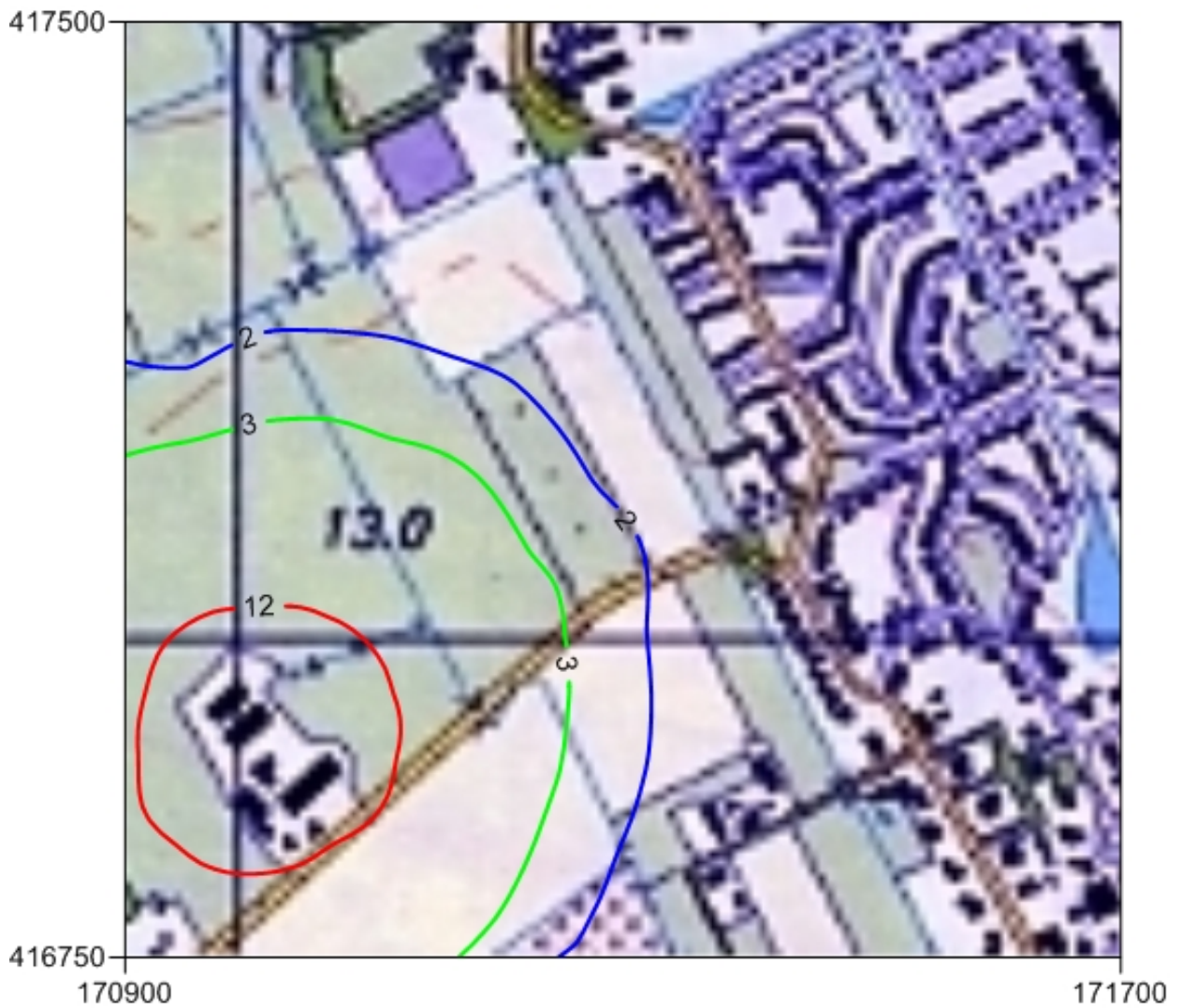
Figuur b Geurcontouren van 2, 3 en 12 ou_E/m^3 als gevolg van veehouderij A. Albers berekend met V-Stacks gebied
