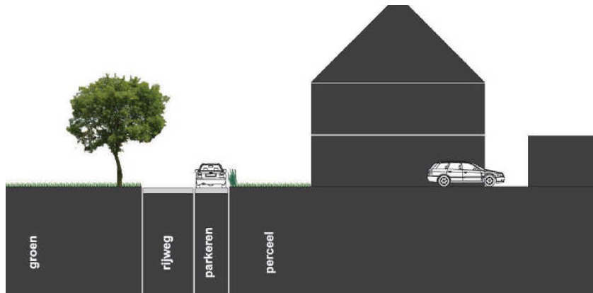
Doorsnede straatprofiel deelgebied 5 (Bron: Beeldkwaliteitsplan Repelakker, BRO, april 2010)
