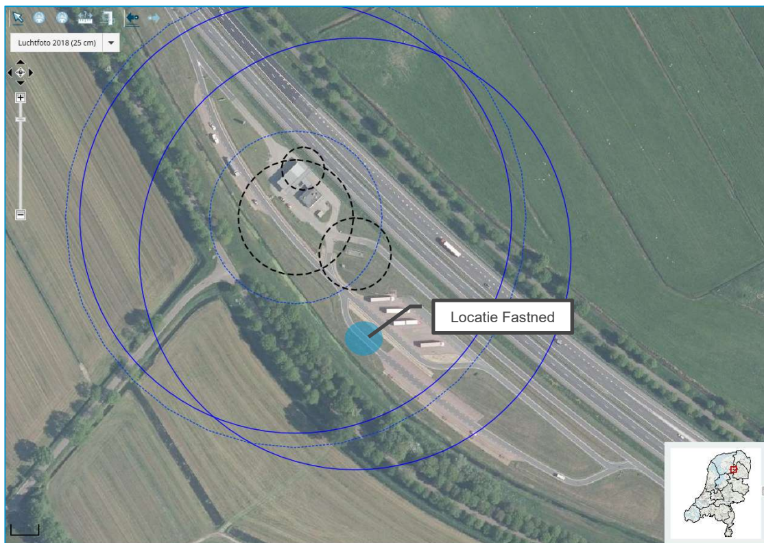
Figuur: EV-Signaleringskaart LPG-tankstation
