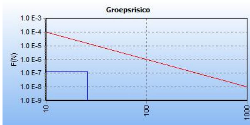
Figuur 11: Maatgevende FN curve voor Vermilion 10inch Wapse-Vinkegaleiding 08-07-2014 van Vermilion Oil & Gas Netherlands BV voor de kilometer tussen stationing 4750.00 en stationing 5750.00
