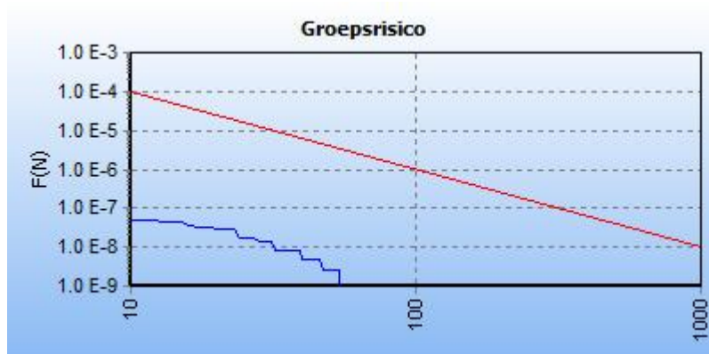
Figuur 12: FN curve voor tussen stationing 2250.00 en stationing 3250.00 nabij de Stichting Trajectum
