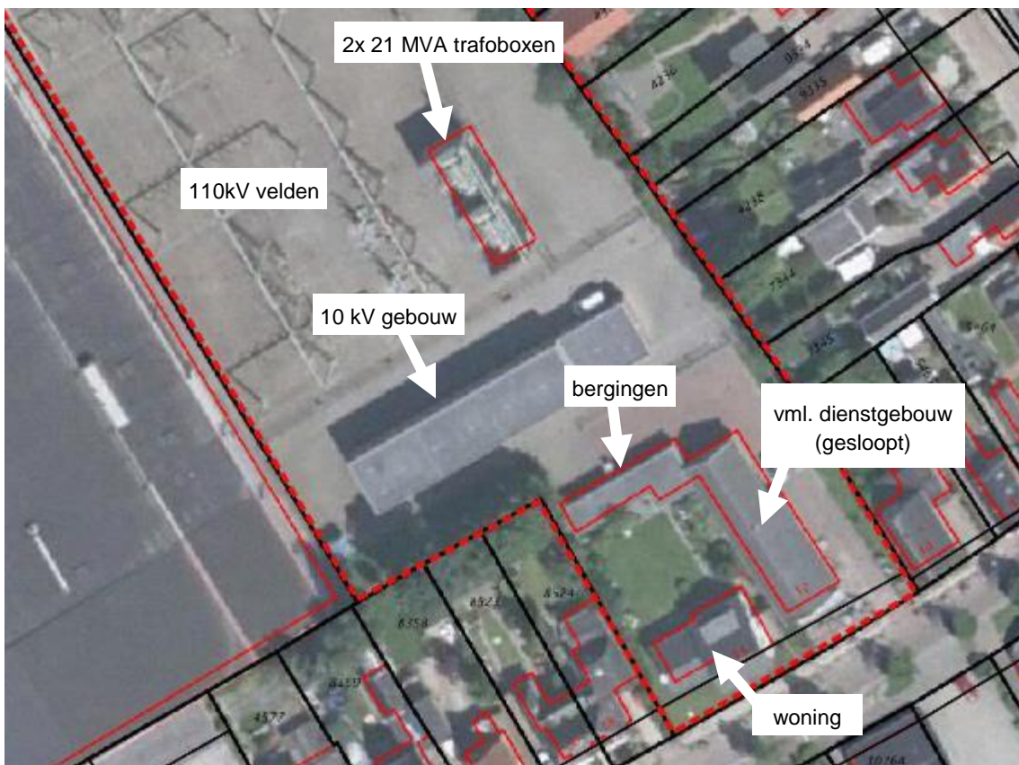
afbeelding 2.3: gebouwen en installaties op het voorste deel van het perceel
