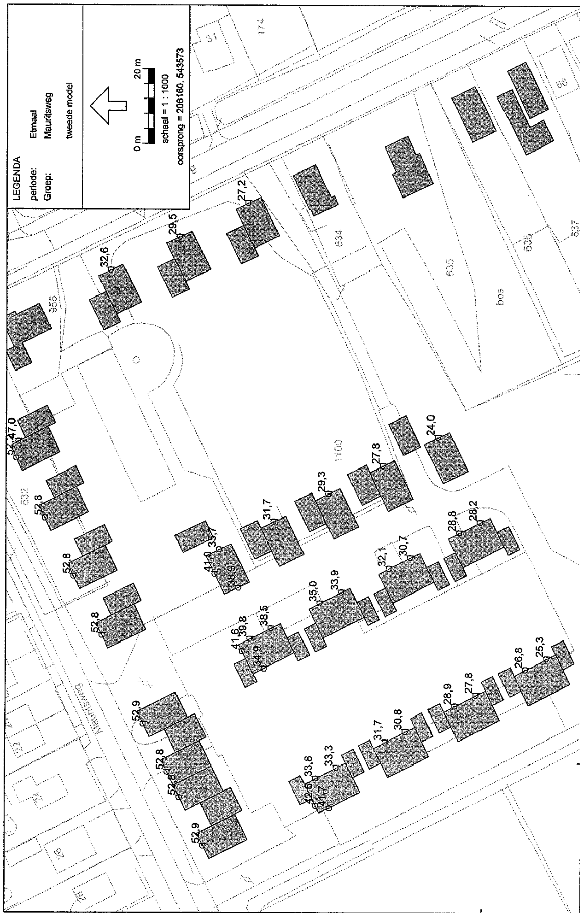
Overzicht van het rekenmodel met per ontvangerpunt aangegeven de berekende etmaalwaarde geluidsniveaus vanwege uitsluitend het wegdeel Mauritsweg
