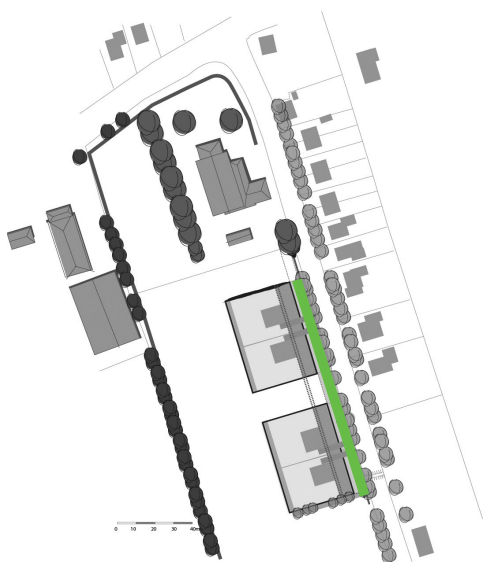
Kabels en leidingen toegankelijk voor beheerders
