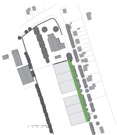
Kabels en leidingen toegankelijk voor beheerders
