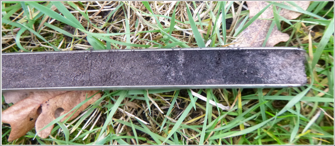
Figuur 7: Oldeholtgade, Hamersweg: Het veenlaagje zoals dat in diverse boringen is aangetroffen.
