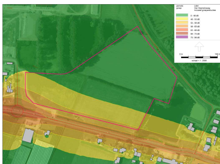
Figuur 4.3: Impressie van de geluidscontouren ten gevolge van de Van Heemstraweg inclusief geluidsreducerend asfalt (waarneemhoogte 7,5 meter)
