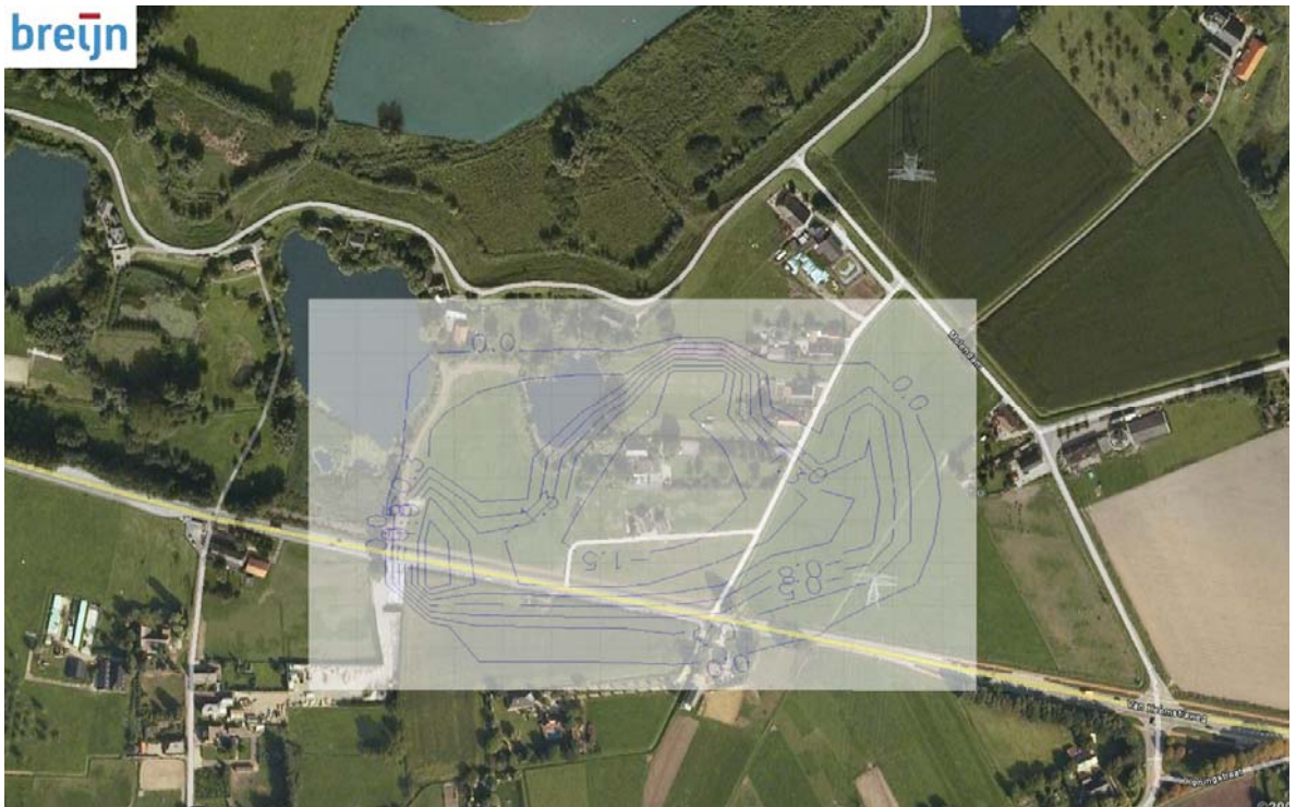
Figuur 3 Globale daling grondwater bij een T=10 hoogwaterpiek t.g.v. drainage in meter
