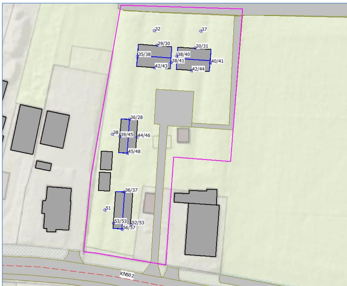
Afbeelding 6 . Geluidbelastingen Lden (excl. aftrek art. 110g Wgh) cumulatief Berekende geluidbelastingen op een hoogte van 1,5 / 4,5 meter
