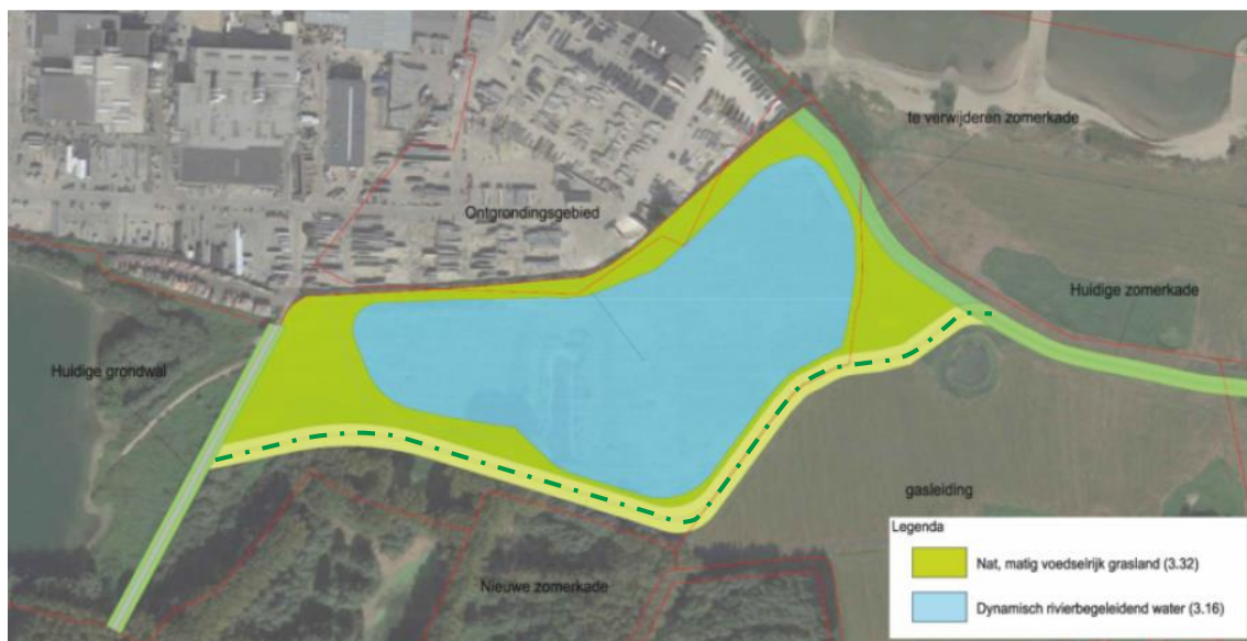
Figuur 2.2: Voorlopige inrichting van de riviercompensatie, de te verleggen zomerkade is hier met een doorbroken lijn aangegeven
