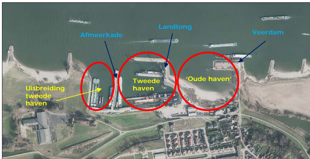
Uitsnede luchtfoto (2013) ter hoogte van Haven Druten, met daarin globaal aangegeven de dichtgeslibde 'oude haven', de tweede haven, als ook de uitbreiding van de tweede haven
