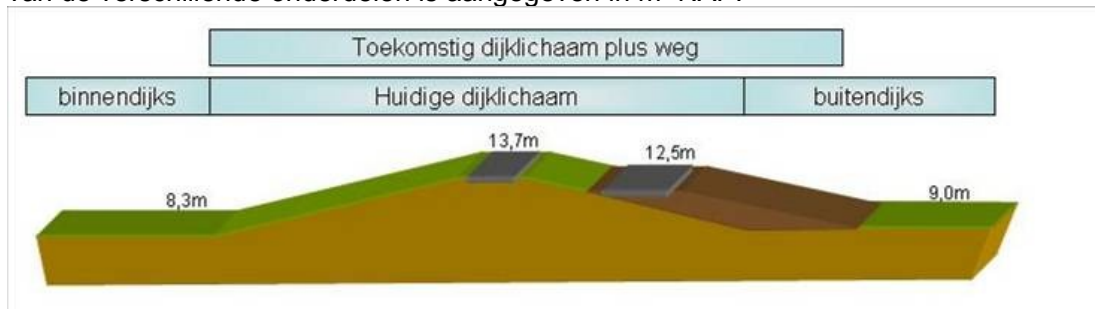
Figuur 5.1. Schematisch dwarsprofiel huidige dijk en nieuwe weg. De maaiveldhoogte van de verschillende onderdelen is aangegeven in m+NAP.
