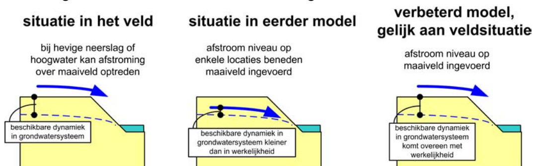
afbeelding 3.2. Schematisch overzicht verbetering afvoer over maaiveld
