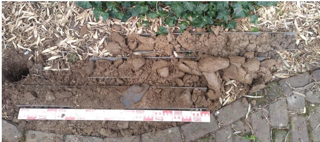
Afbeelding 16: Boorkern van boring B04. De leesrichting (volgorde) is van links beneden naar rechts boven.
