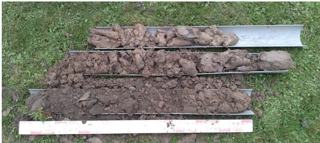
Afbeelding 15: Boorkern van boring B02. De leesrichting (volgorde) is van links beneden naar rechts boven.
