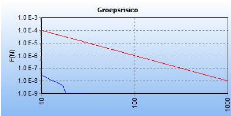
5.2 Figuur 5.2 FN curve voor 8348_leiding-N-575-60-deel-1 van N.V. Nederlandse Gasunie voor de kilometer tussen stationing 0.00 en stationing 0.00
