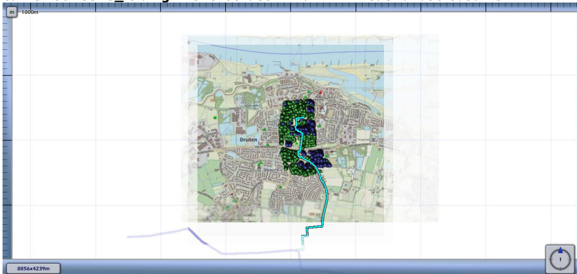
Figuur 4.2 Kilometer leiding behorende bij de maximale overschrijding van de FN-curve voor 8348_leiding-N-575-60-deel-1 van N.V. Nederlandse Gasunie
