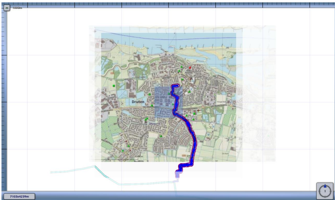
3.2 Figuur 3.2 Plaatsgebonden risico voor 8348_leiding-N-575-60-deel-1 van N.V. Nederlandse Gasunie
