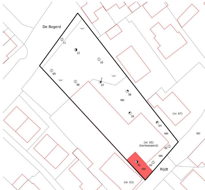
Kaart met boorpunten van het bodemonderzoek, in de rode vlek is verontreiniging aangetroffen
