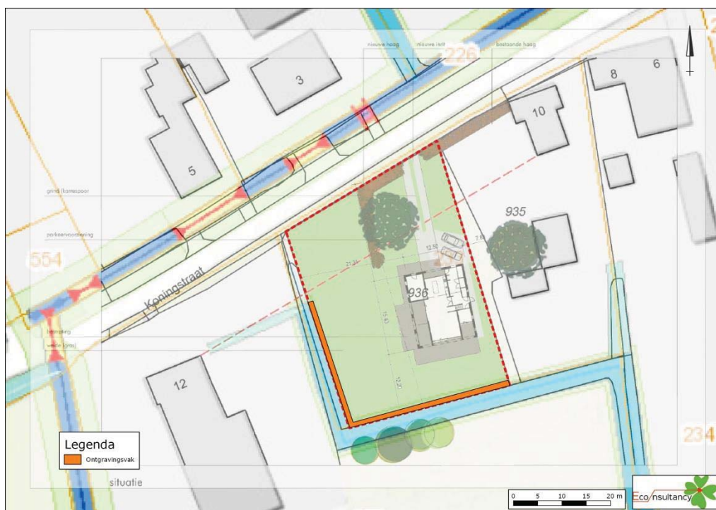
Figuur 5: Te ontgraven deel t.b.v. vergroten bergingscapaciteit watersysteem
