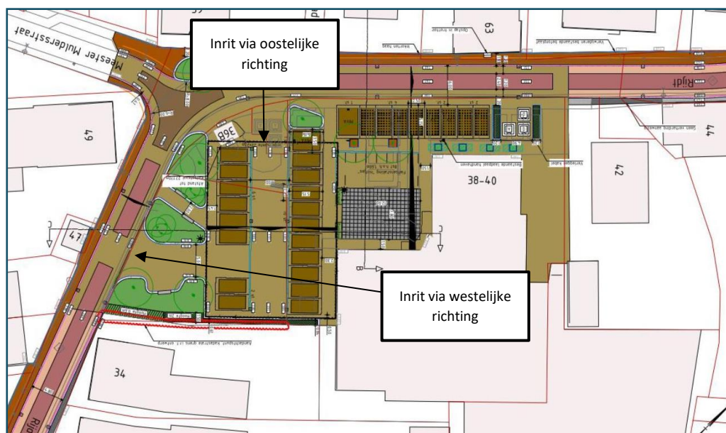
Figuur 3 Situatie van de nieuwe parkeervoorziening met inrit via westelijke en oostelijke richting
