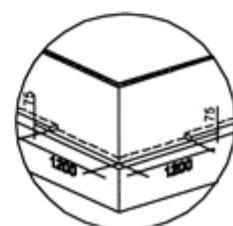
spouwisolatie in de hoek over 1200 mm doorgezet
