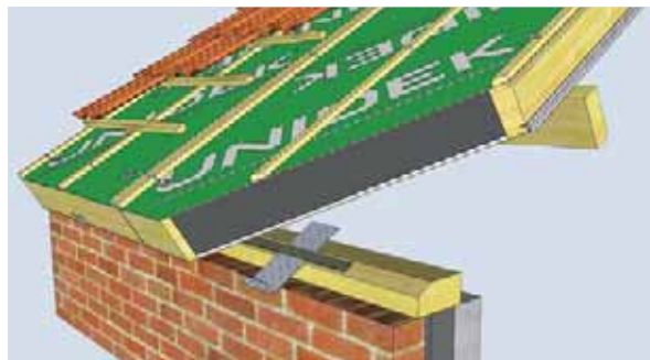
Figuur 1 Detail muurplaat met afschuifanker
