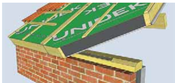
Figuur 2 Detail muurplaat zonder afschuifanker
