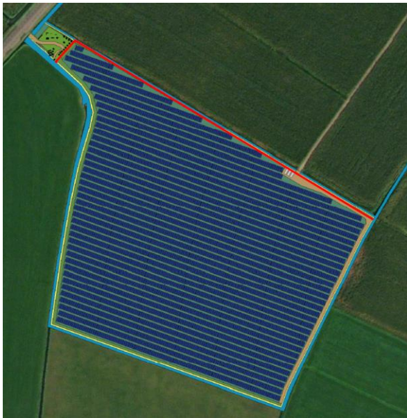
Figuur 10: de groene lijn geeft aan waar rietoevers aangelegd zullen worden die in de lente, zomer en herfst het zonnepark gedeeltelijk of volledig van het zicht zullen onttrekken. De rode lijn geeft de locatie van het te bouwen hekwerk aan.
