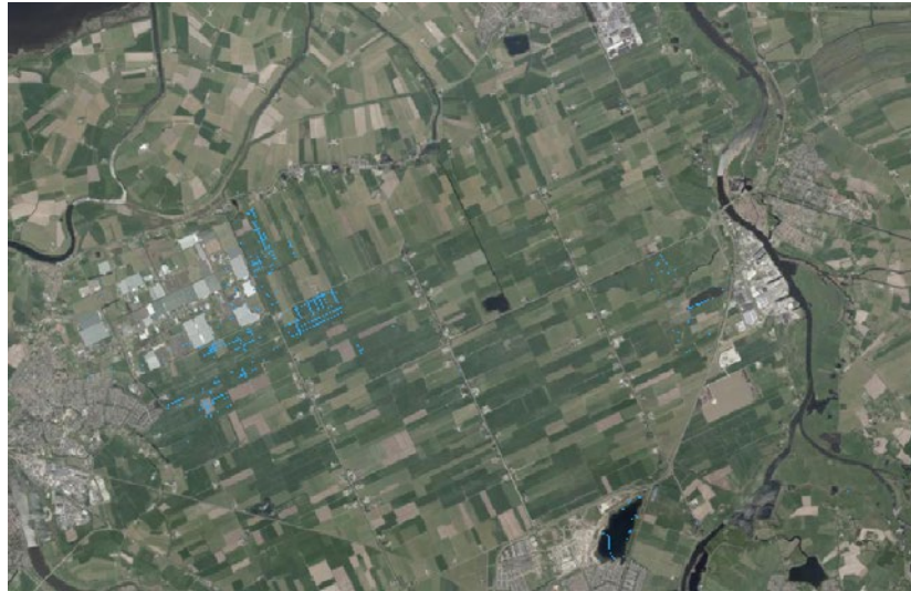
Figuur 6.3.7 Gebieden waar de GLG in de referentiesituatie buiten de bandbreedte -0,30 en -0,10 centimeter ten opzichte van maaiveld lag en na toepassing van het scenario 2A binnen deze bandbreedte lag (in blauw).
