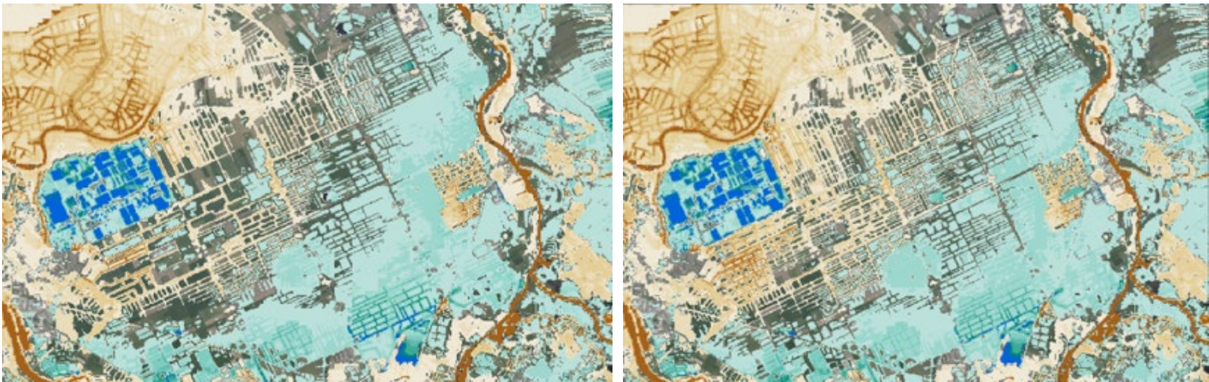
Figuur 6.1.18 kwel (blauw) en wegzijging (geel-bruin) in de Mastenbroek. Links de huidige situatie. Rechts de situatie na toepassing van werkscenario 2a
