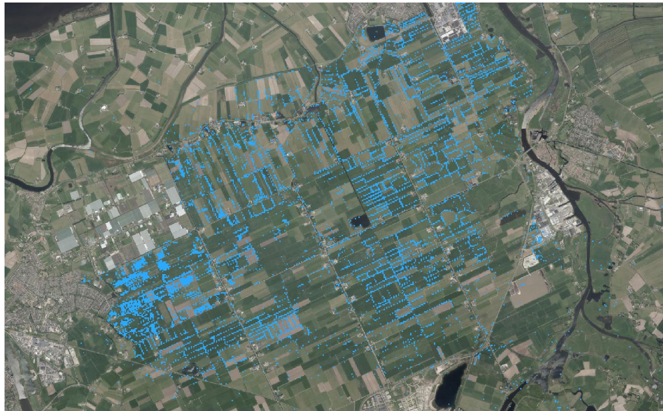
Figuur 6.3.6 Gebieden waar de GHG in de referentiesituatie buiten de bandbreedte -0,30 en -0,10 centimeter ten opzichte van maaiveld lag en na toepassing van het scenario 1A/1B binnen deze bandbreedte lag (in blauw).
