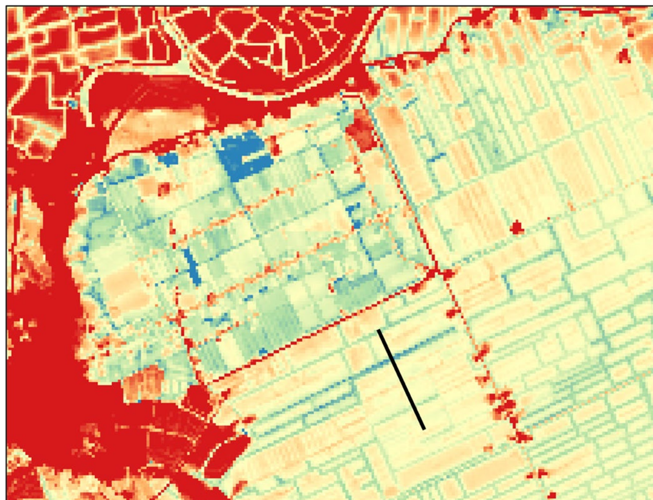
Figuur 6.1.6: De figuren tonen de berekende gemiddelde laagste grondwaterstand (GLG) voor de 'huidige situatie' (peilenkaart 2021, huidig klimaat (zie bijlage C)). De GLG's zijn weergegeven in meters ten opzichte van maaiveld. De bovenste figuur toont de situatie voor de gehele polder Mastenbroek, de onderste is ingezoomd op de Koekoekspolder
