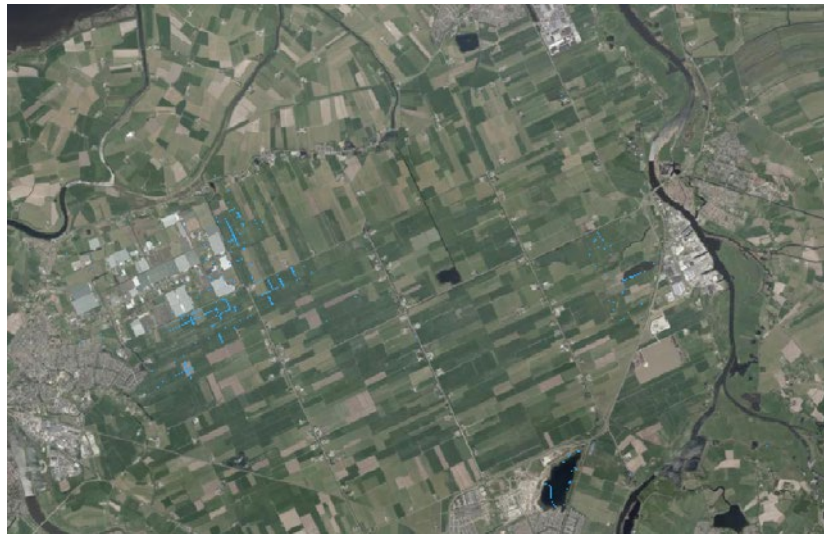
Figuur 6.3.9 Gebieden waar de GLG in de referentiesituatie buiten de bandbreedte -0,30 en -0,10 centimeter ten opzichte van maaiveld lag en na toepassing van het scenario 2B binnen deze bandbreedte lag (in blauw).
