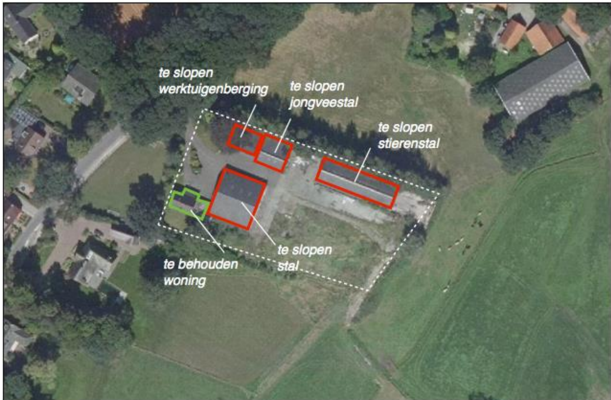
Figuur 3.1 Overzicht te slopen en te behouden bebouwing (Bron luchtfoto: Provincie Overijssel)
