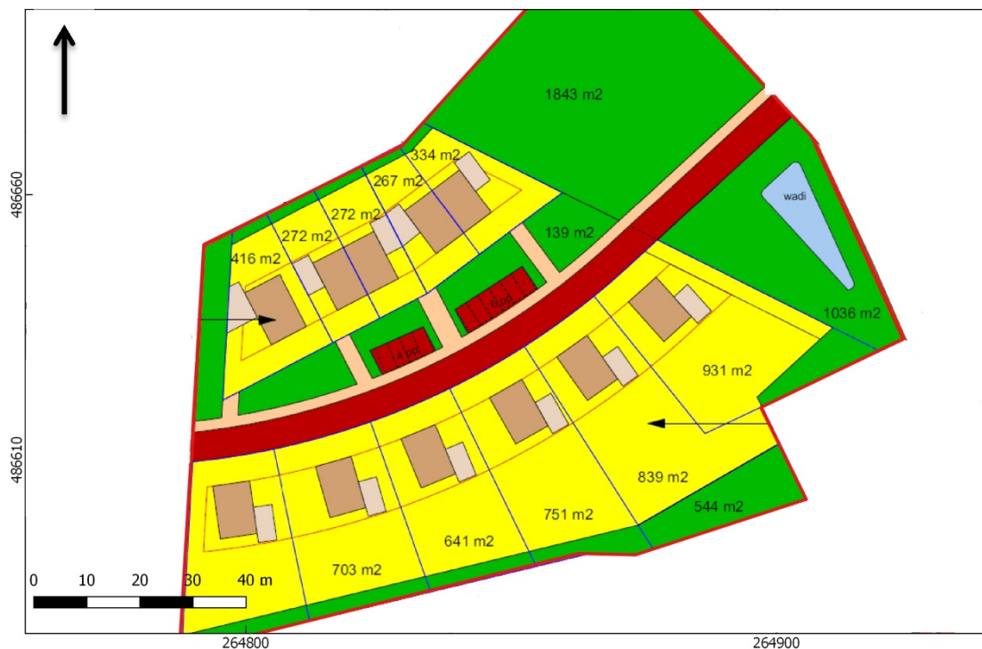
Afbeelding 2. Nieuwe situatie. Donkerrood en zalmroze: infrastructuur; lichtbruin: bebouwing; geel: erf en tuin; groen: groenzones; lichtblauw: wadi.
