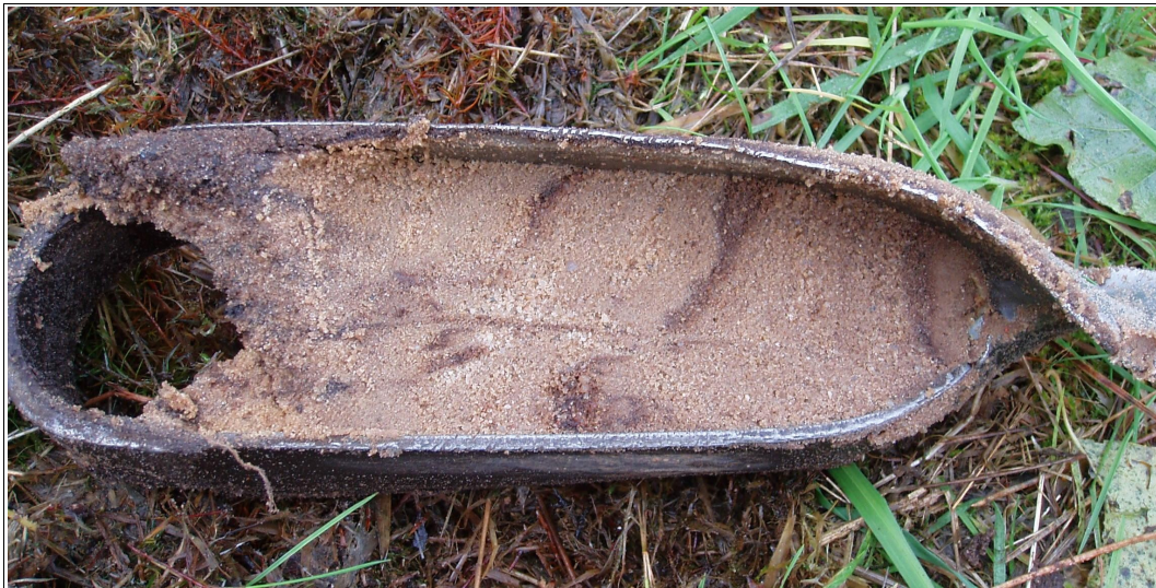
Figuur 8: Losser, Denekamperdijk 59: monster boring 1, 60 - 70 centimeter beneden maaiveld. In de boorkop zit een gelaagde zandafzetting met grofkorrelige niveaus, fijnkorrelige niveaus, lemige niveaus en humeuze niveaus. Waarschijnlijk is de afzetting een combinatie van door de Dinkel aangevoerd, en door de wind afgezet materiaal.
