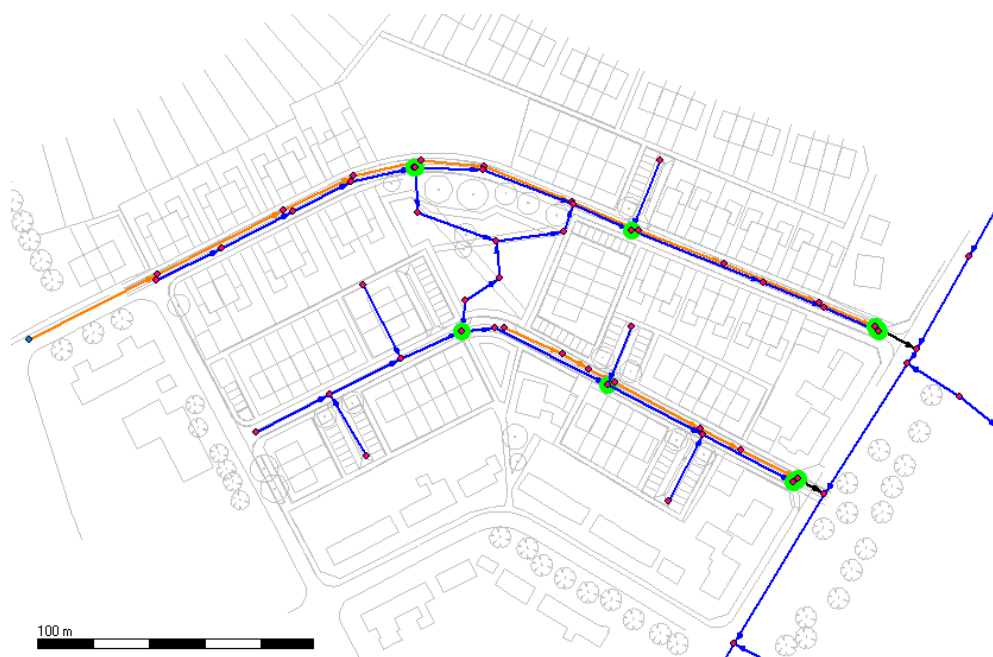
Figuur 6: Schematisatie drainagestelsel. (groene stippen: interne overstort, blauw: drainagesysteem, oranje lijn: hemelwaterafvoer, rode stip: putten)
