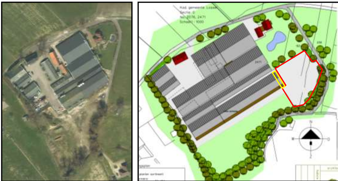
Figuur: luchtfoto plangebied (bron: provincie Overijssel) en uitsnede inrichtingsplan nieuwe situatie (in rood de nieuwe biggenlaadplaats, in geel de technische ruimte t.b.v. de luchtwasser)
