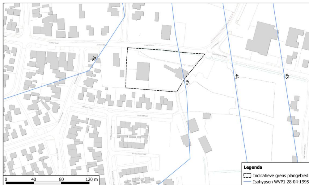
Figuur 4: Isohyphenpatroon van het eerste watervoerende pakket op basis van de grondwaterstanden op 28 april 1995 [6].
