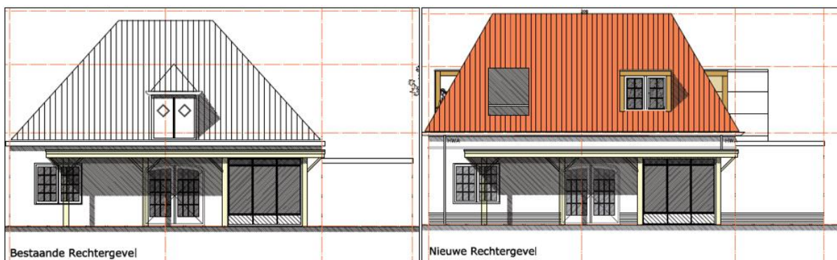
Afbeelding 3.4: Aanzicht bestaande (links) en nieuwe (rechts) rechtergevel (Bron: BASPIT Bouwkundig Adviesbureau)
