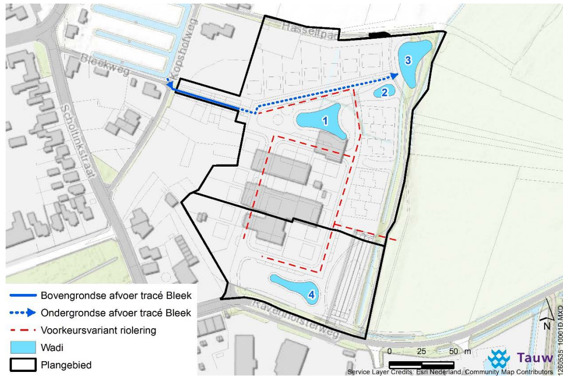
Figuur 3.5 Afwatering de Bleek en voorkeursvariant vuilwaterafvoer
