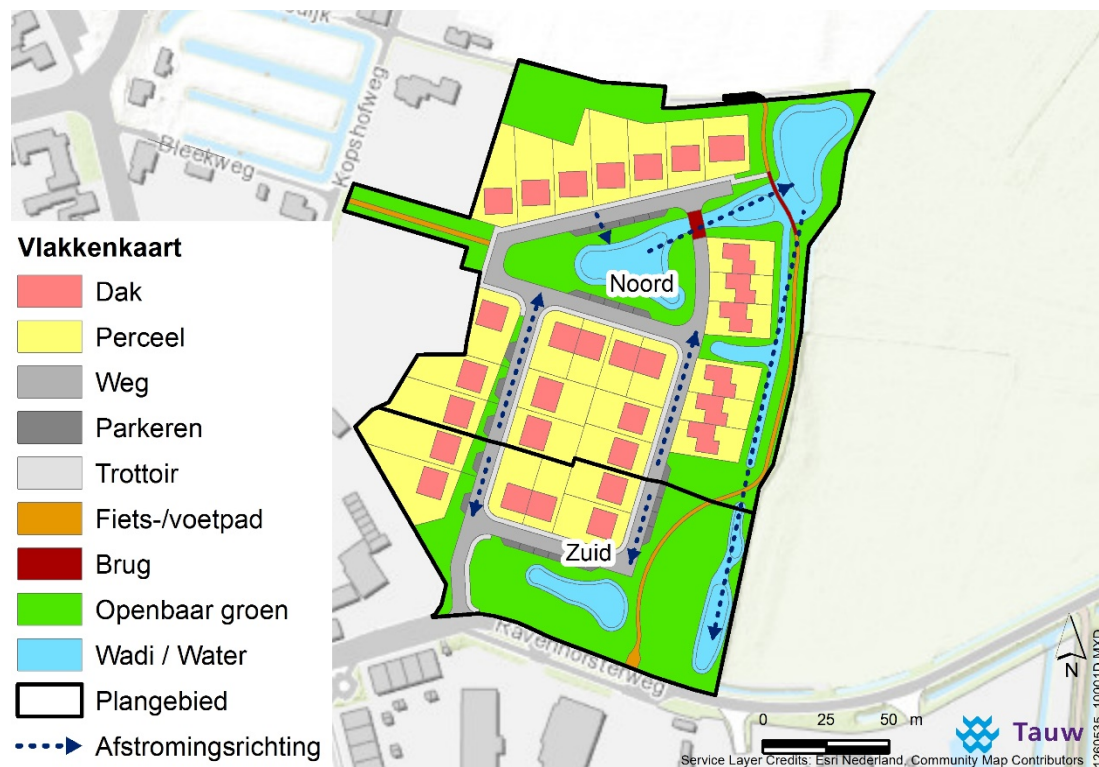
Figuur 3.3 Vlakkenkaart en afvoerstructuur hemelwater
