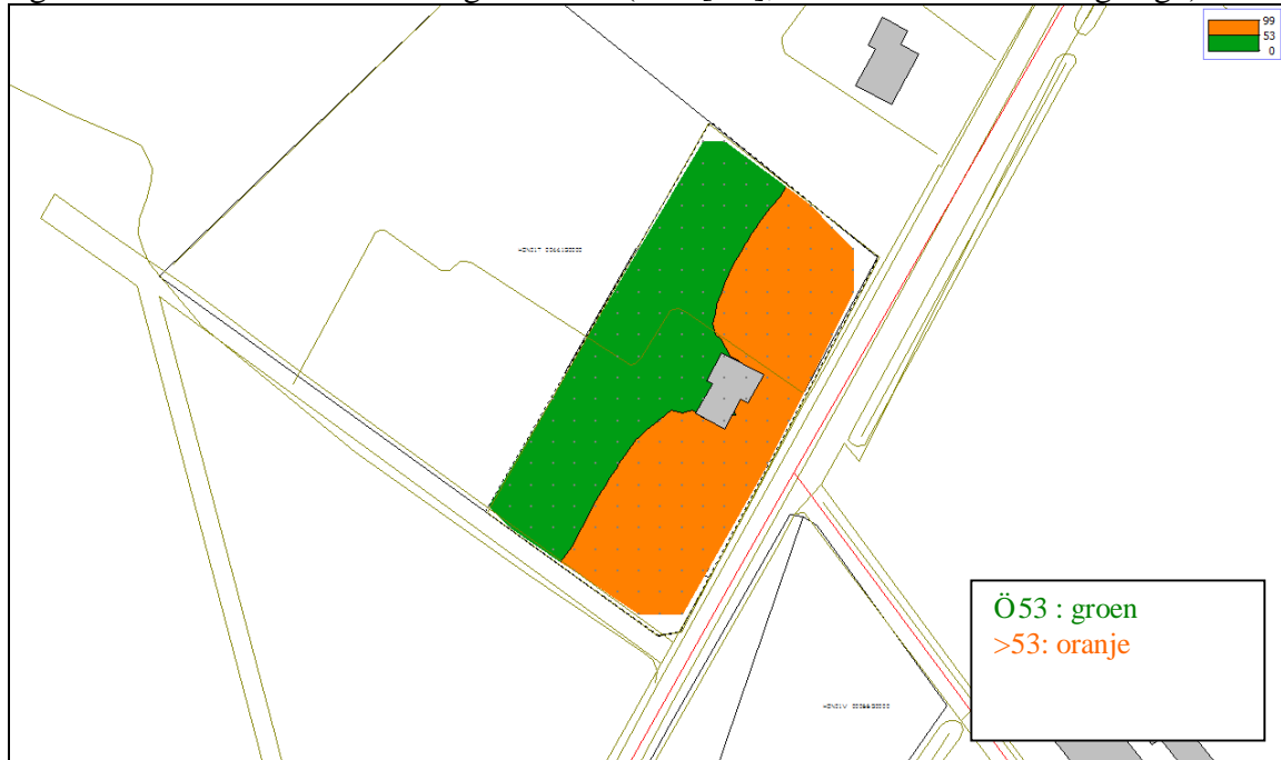
figuur 4: resultaten voor alle wegen samen ( L_{den} [dB], excl. correctie art.110g Wgh)
