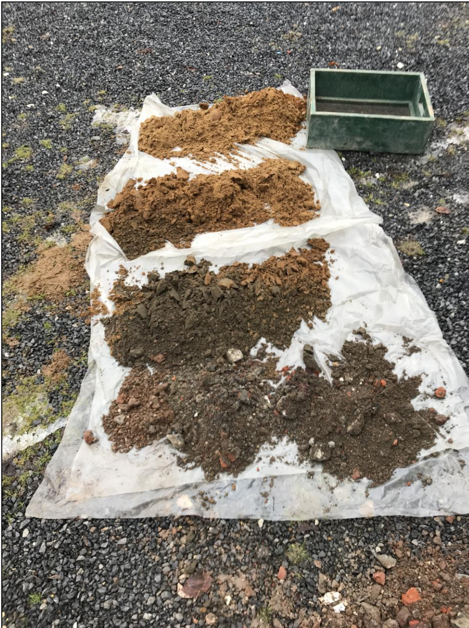
Figuur 11: Boring 1 uitgelegd. Linksonder maaiveld, rechtsboven het diepste punt van de boring.
