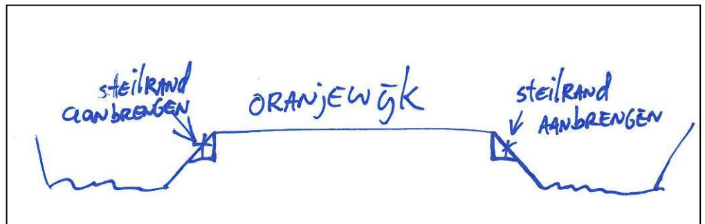
Figuur 1: dwarsdoorsnede plangebied en tochtsloten
