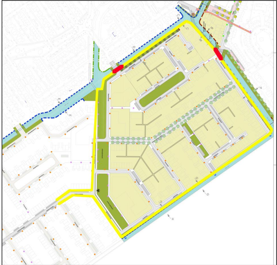
Figuur 2: Amfibieënkering Oranjewijk. De gele lijnen betreffen het tracé van de greppel. De twee rode blokken zijn de amfibieënschermen op de dammen naar de Zeewijk en de Polderwijk
