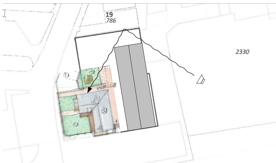
f6.4 Illustratie geluidreflecties via bestaande bebouwing
