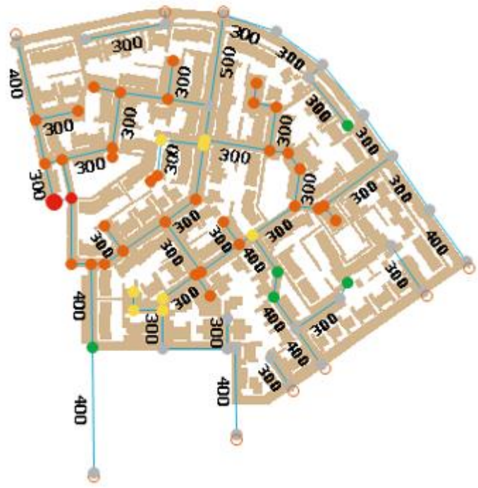
Water op straat bij een klimaatbui met waterpeil 4.8m–NAP (Stresstest)
