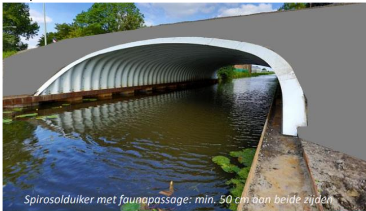
Figuur 5: Mogelijk ontwerp van de duiker onder de Urkerweg.
